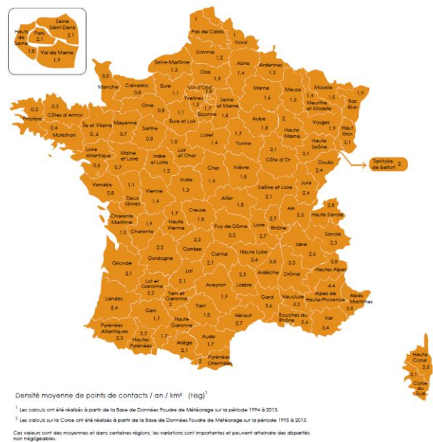
Figure 27 : Carte de la densité de foudroiement de la France issue de la norme NFC 17-102 (05-2015)
